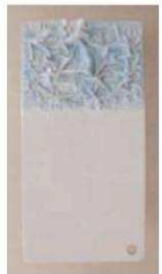
Pintura PU bicomponente DECAPANTE 7AE855 Comienzo del craquelamiento después de 9 minutos de contacto
