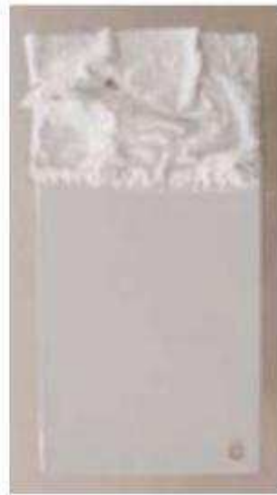
Pintura PU bicomponente DECAPANTE CLÁSICO a base de cloruro de metilo Comienzo del craquelamiento después de 12 minutos de contacto
